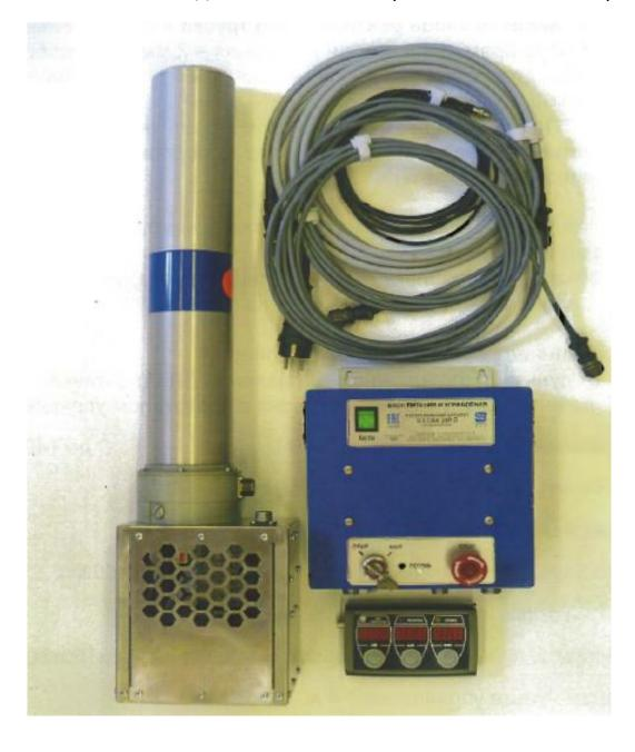
Аппарат выпускается в трех модификациях в зависимости от типа установленной в моноблоке рентгеновской трубки с различными размерами фокусного пятна и, соответственно, различной максимальной мощностью излучения на аноде рентгеновской трубки:
