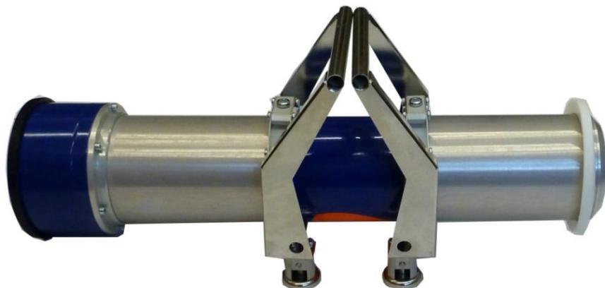
Запатентованное устройство состоит из пары пластиковых колец, плотно одеваемых на моноблок симметрично относительно положения фокусного пятна. Под каждым кольцом находится стальная ось с дугами и ручками с одной стороны и подвижными креплениями с постоянными магнитами – с другой стороны.
