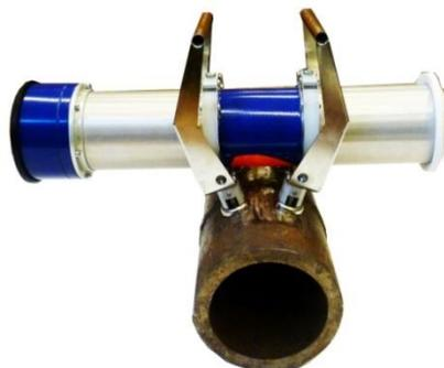
Оператор может установить моноблок с устройством над сварным швом как перпендикулярно, так и параллельно «просвечиваемой» трубе, в зависимости от наличия свободного пространства вокруг шва на трубе.
